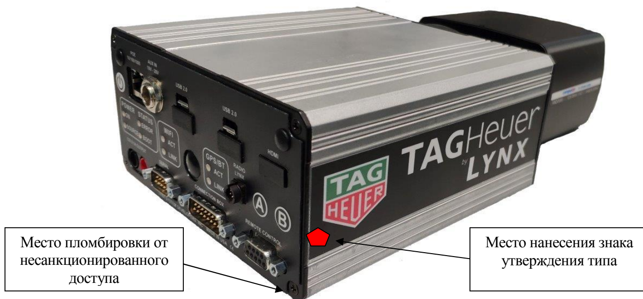
Рисунок 2 - Общий вид и схема пломбировки от несанкционированного доступа камеры системы автоматизированной TAG Heuer by Lynx
