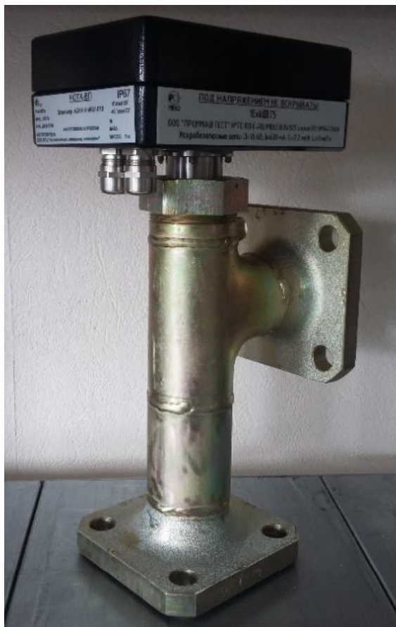
Рисунок 1 – Общий вид влагомера НОТА-ВП в исполнении 1
