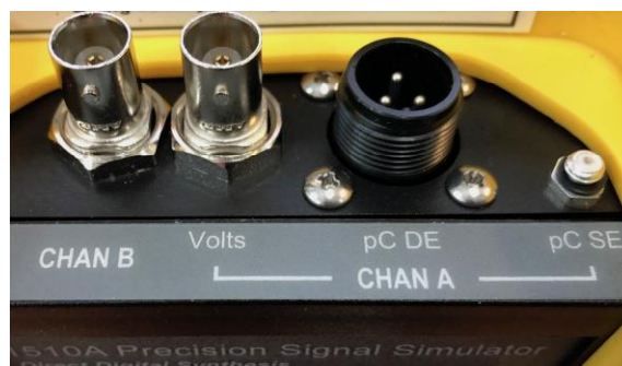
Вид разъемов на торцевой стороне генераторов
