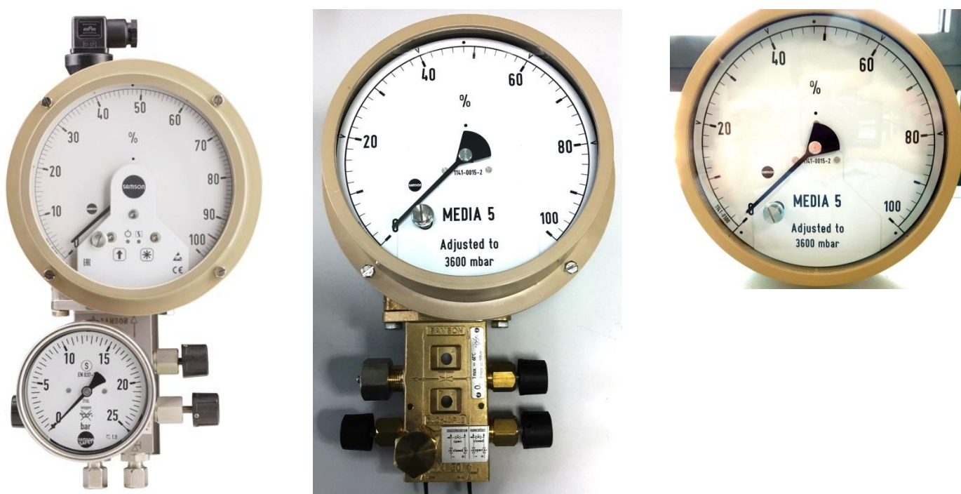
Рисунок 2 - Общий вид манометров дифференциальных показывающих Media 5
