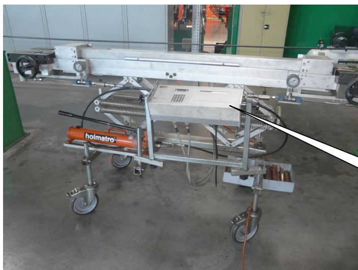
Рисунок 1 – Общий вид устройства измерительного электрического сопротивления и площади поперечного сечения жил кабеля AESA 8135
