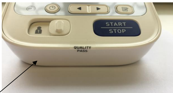
Место нанесения защитной наклейки от несанкционированного доступа
