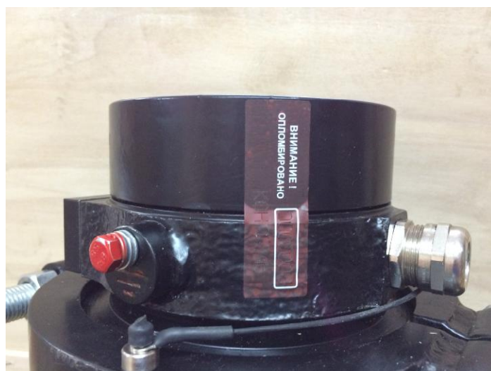
Рисунок 2 – Схема пломбировки от несанкционированного доступа, обозначение места нанесения знака поверки на корпус и крышку турбинного преобразователя расхода
