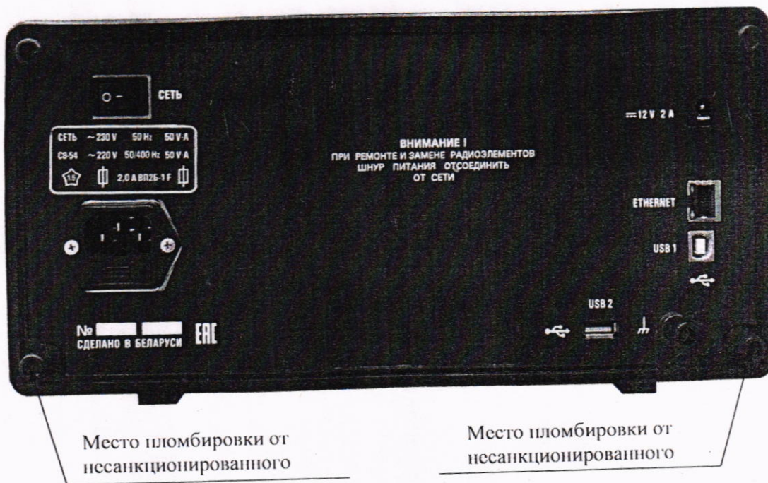
Рисунок 3.1 – Схема пломбировки от несанкционированного доступа
