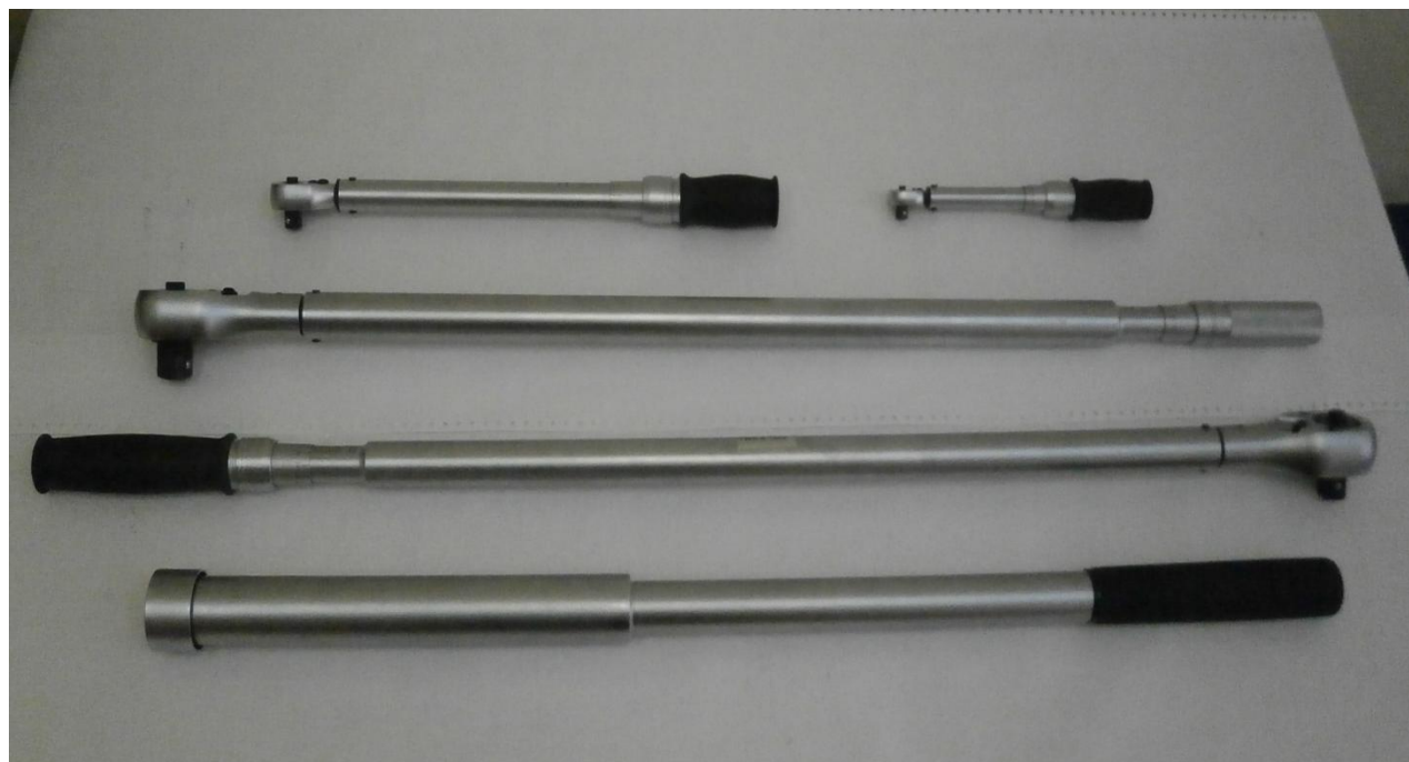
Рисунок 1- Общий вид ключей моментных предельных TWR
