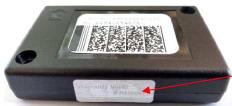
Рисунок 3 - Место пломбировки от несанкционированного доступа (вариант пломбировки № 2)
