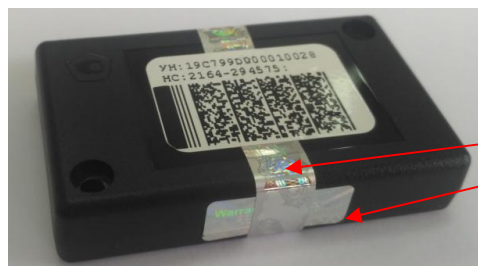
Рисунок 2 - Места пломбировки от несанкционированного доступа (вариант пломбировки № 1)
