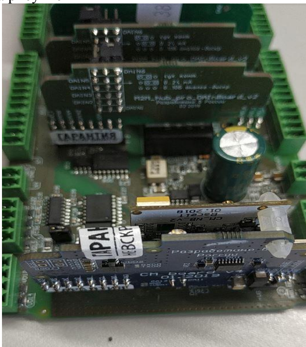
Рисунок 2 – Место установки защитной наклейки, блокирующей доступ к технологическому разъему для прошивки УСПД.
