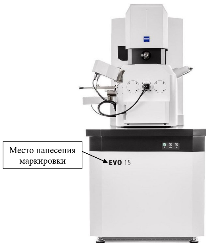
Рисунок 3 – Общий вид микроскопов сканирующих электронных серий EVO с обозначением места нанесения знака поверки
