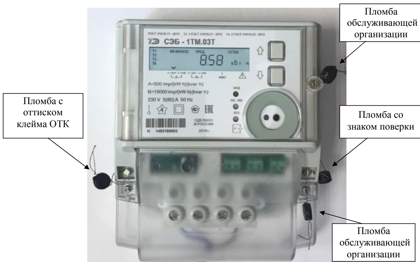
Рисунок 1 – Общий вид счетчика внутренней установки, схема пломбировки от несанкционированного доступа, обозначение места нанесения знака поверки
