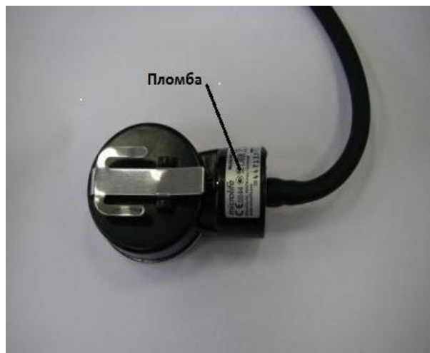
Рисунок 4 – Место пломбирования приборов для измерения артериального давления моделей BP AG1-10, BP AG1-20, BP AG1-30
