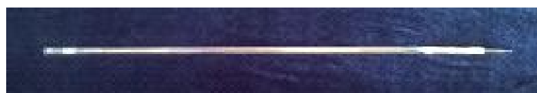
Рисунок 3 - Общий вид бюретки без установленного времени ожидания и без крана тип 1 исполнение 3
