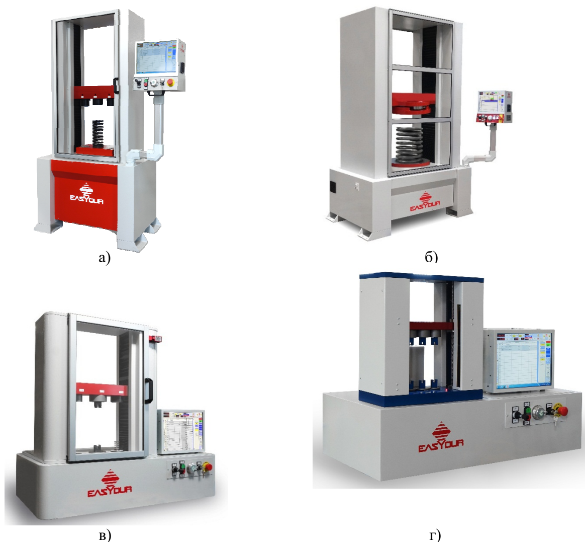
Рисунок 1 – Общий вид машин испытательных EASYDUR а) 3MZ1 TRIPLE, 3MZ2.5 TRIPLE, 3MZ5 TRIPLE; б) AURA10, AURA30, AURA60, AURA100; в) DYNO TRIPLE; г) MICRODYNO TRIPLE
