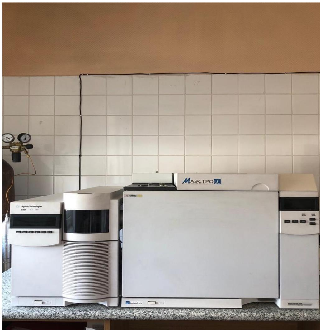
Рисунок 1 - Общий вид хроматографы газового Маэстро GX 7820 с масс-селективным детектором Agilent 5975
