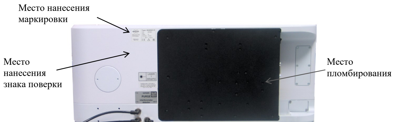
Рисунок 2 – Схема пломбировки от несанкционированного доступа, обозначение места нанесения знака поверки и маркировки
