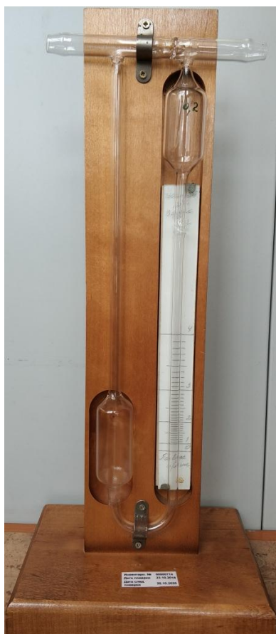
а) Реометр стеклянный лабораторный типа РДС заводской номер 0,2
