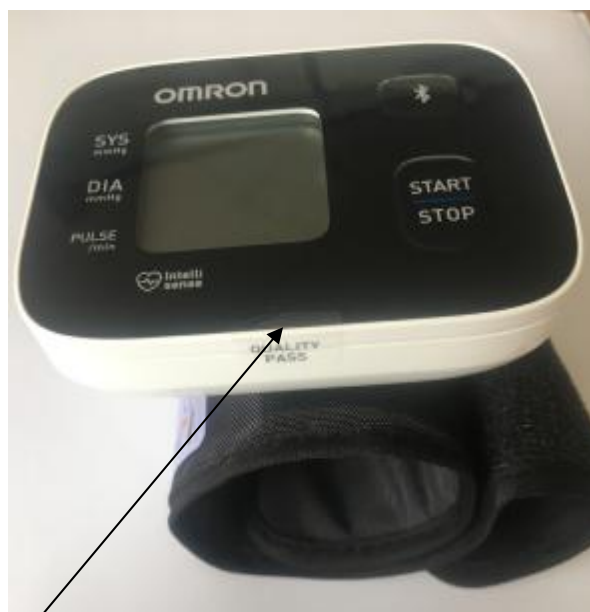
Место нанесения защитной наклейки от несанкционированного доступа Рисунок 3 – Место нанесения защитной наклейки (пломбировка прибора) RS2 Intelli IT (HEM-6161T-RU)
