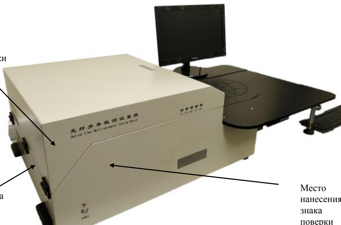
Рисунок 2 – Схема пломбировки от несанкционированного доступа, обозначение места нанесения знака поверки
