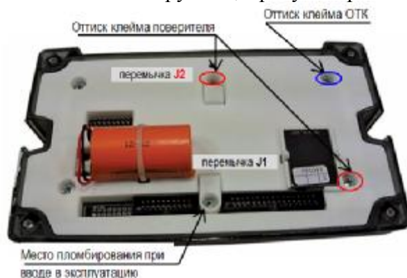
Рисунок 2 – Места пломбирования вычислителя
