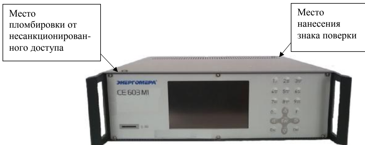
Рисунок 2 - Общий вид ваттметра-счетчика исполнений CE603M1.3-XX-X-X, схема пломбировки от несанкционированного доступа и обозначение места нанесения знака поверки
