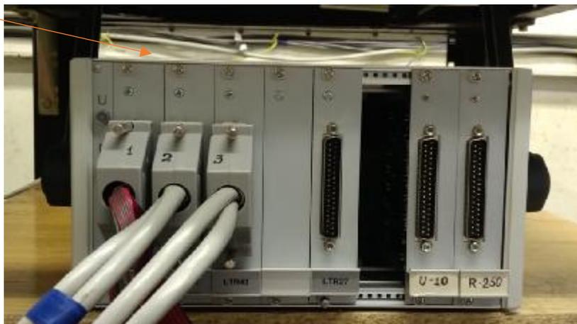
Рисунок 2 – Внешний вид крейта с модулями сбора данных ИВК «ЛУЧ»
