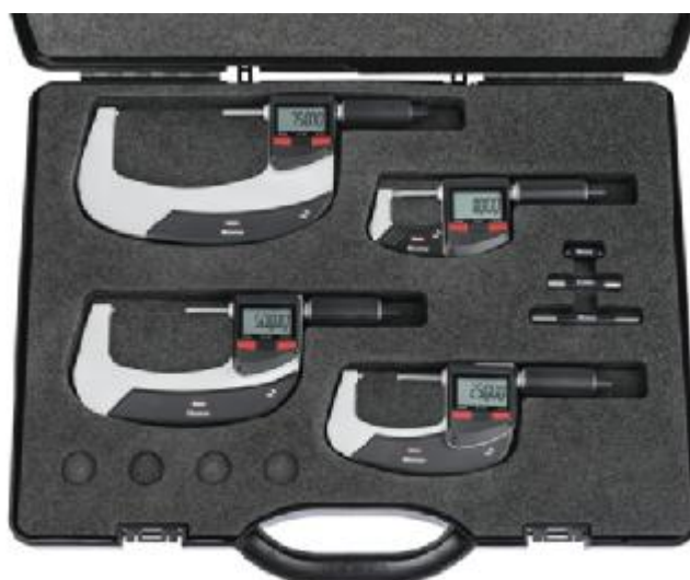
Рисунок 2 – Общий вид набора микрометров моделей 40 EWR, 40 EWRi из 4-х штук
