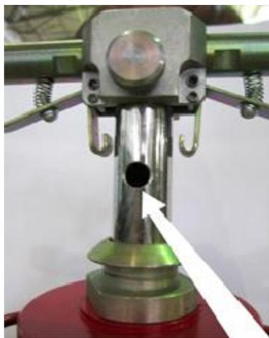
Рисунок 2 – Место пломбировки амортизирующей пружины
