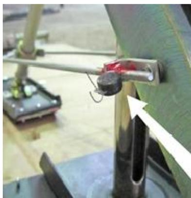
Рисунок 3 – Место пломбировки положения кольца – указателя
