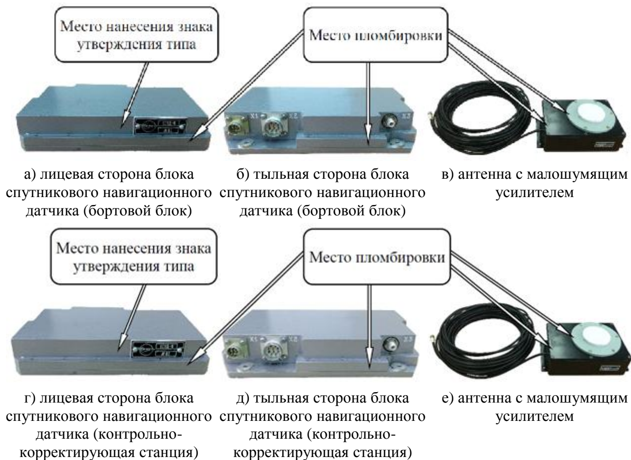
Рисунок 1 — Общий вид бортового устройства ГН
