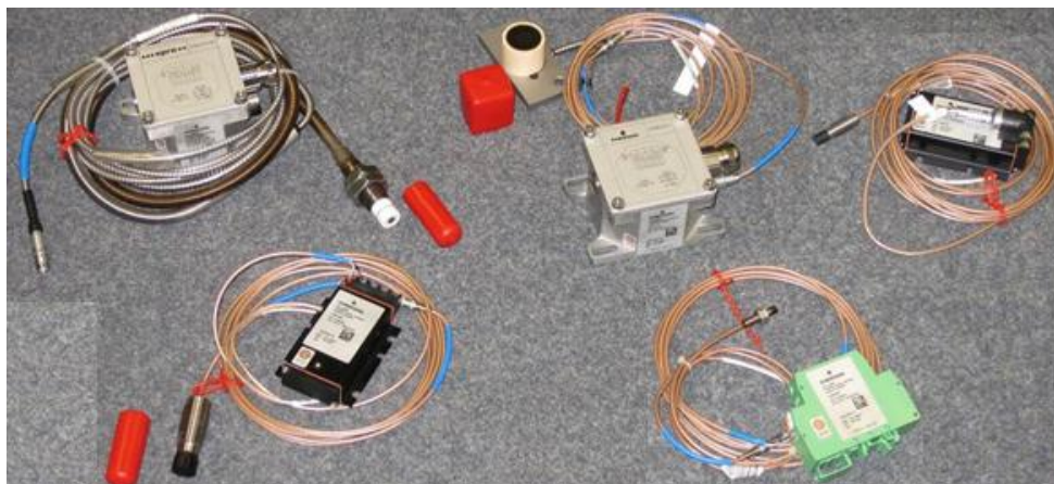
Рисунок 1 – Общий вид датчиков вихретоковых серии PR642X с конверторами сигнала серии CON0X1
