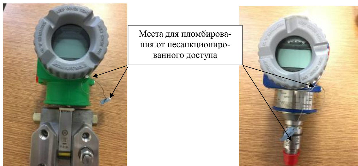
Рисунок 2 – Общий вид преобразователей с обозначением мест пломбирования от несанкционированного доступа
