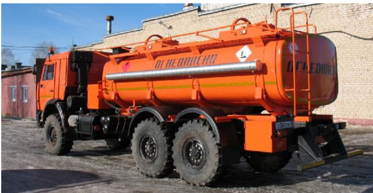
Рисунок 2 – Общий вид автотопливозаправщика ТРАНСМАСТЕР-АТЗ-12,0
