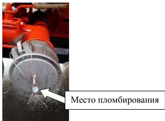
Рисунок 2 – Пломбировка трубопровода слива-налива
