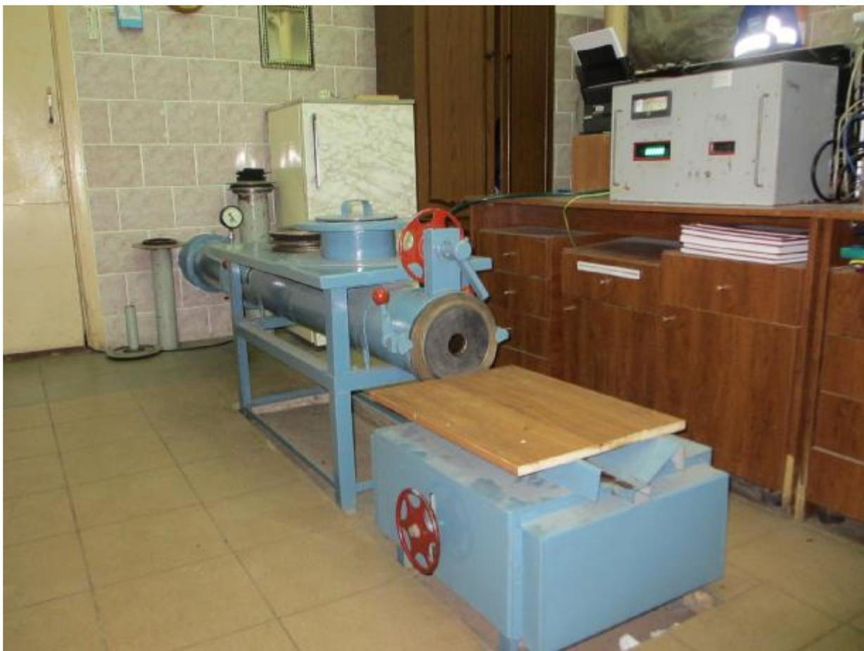
Рисунок 1 – Общий вид установки поверочной УПСГ-1000
