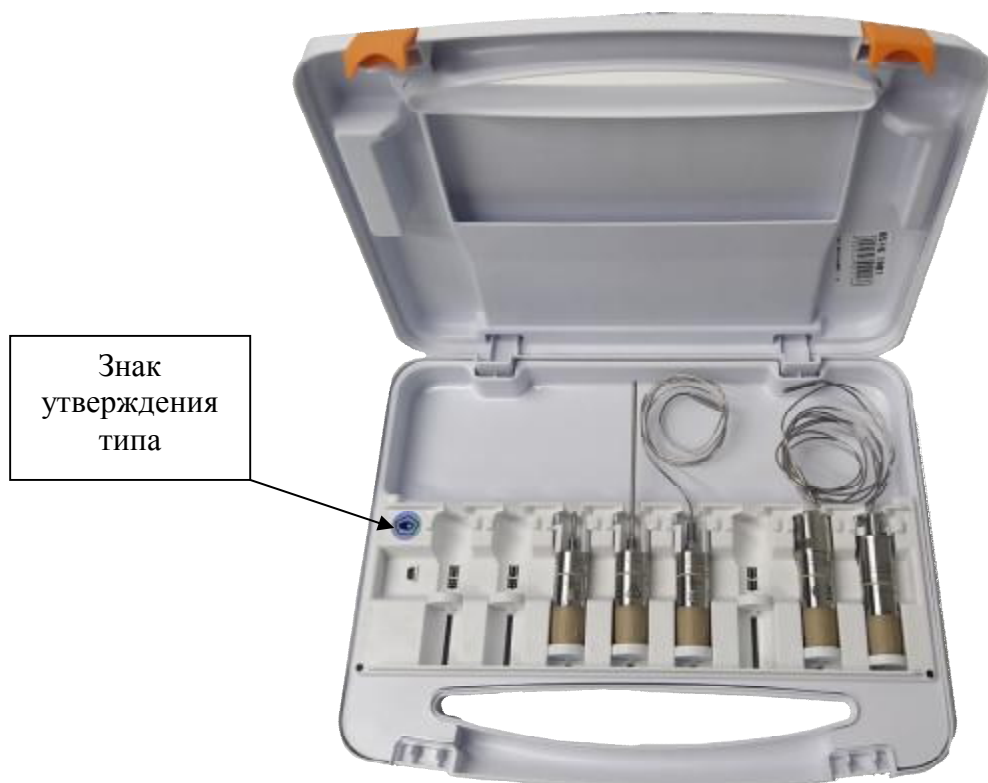
Рисунок 2 - Общий вид блока считывания и конфигурации с уложенными в нем регистраторами беспроводными Testo 190 и место нанесения знака утверждения типа
