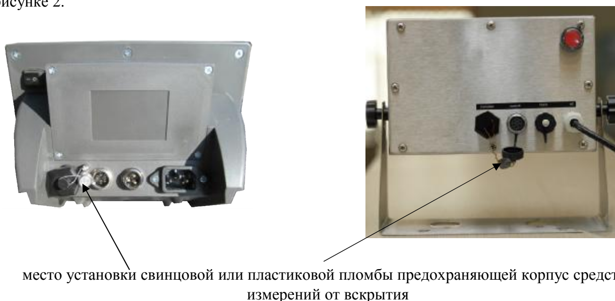
Рисунок 2 – Схема пломбировки средства измерений
