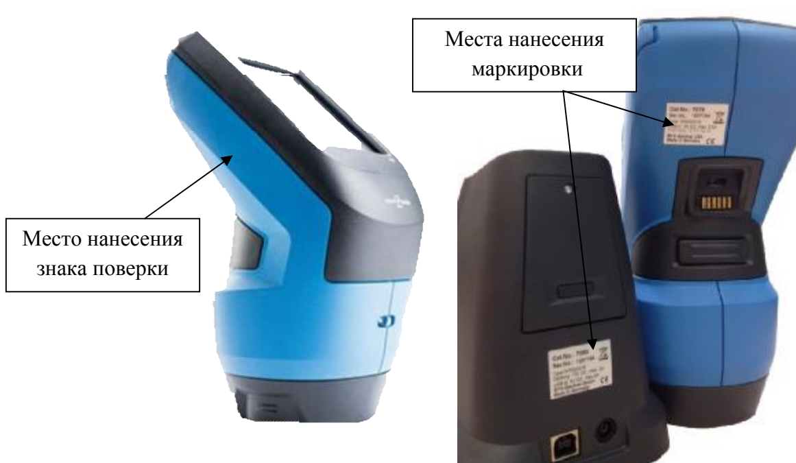
Рисунок 2 – Обозначение места нанесения знака поверки и маркировки
