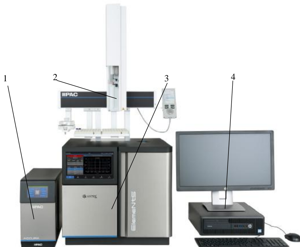
Рисунок 1 – Общий вид анализатора серы и азота ElemeNtS (1 – система ввода газов; 2 - автосамлер для ввода жидких проб; 3 – основной блок анализатора серы и азота ElemeNtS, 4 – персональный компьютер)
