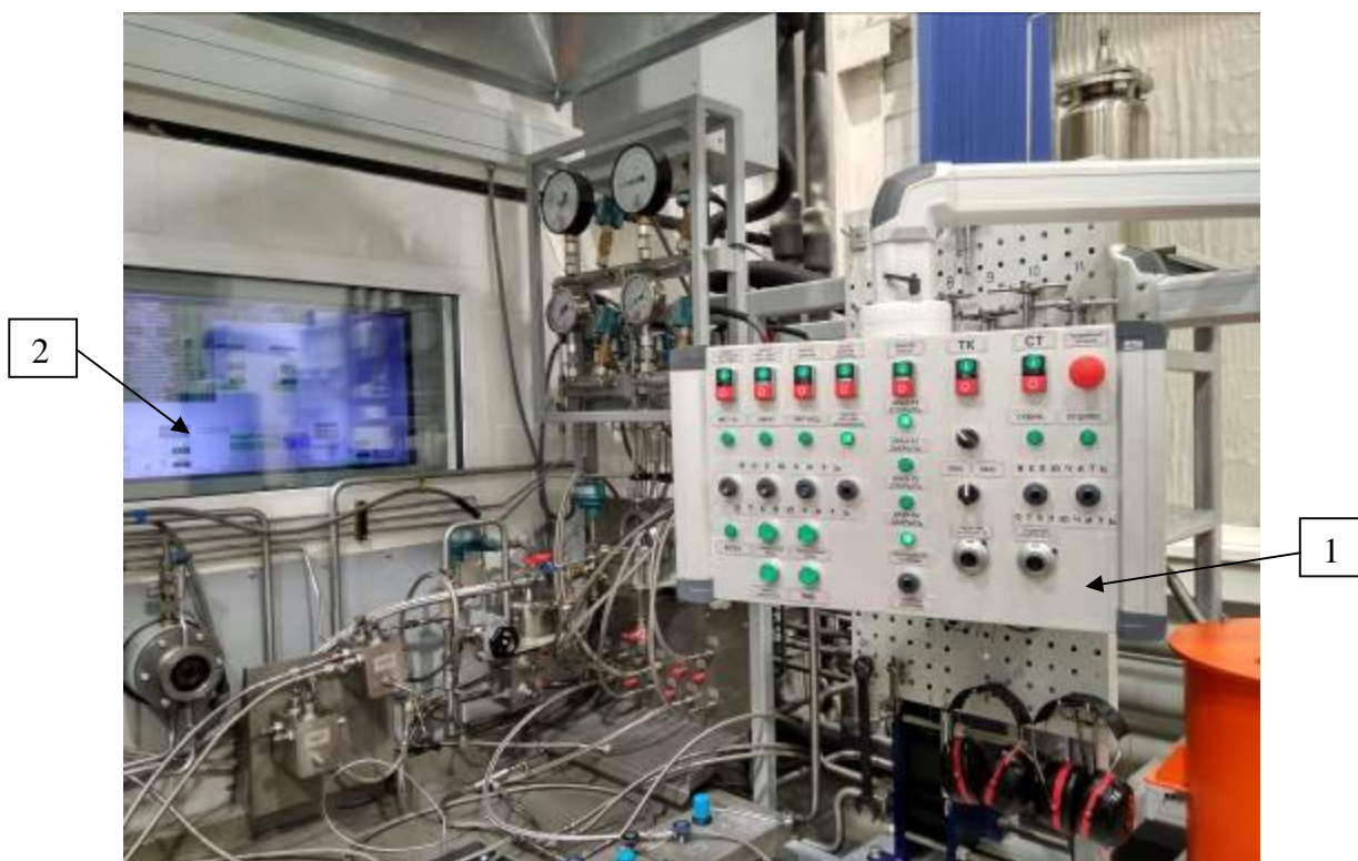
1 – пульт местного управления ПУ2; 2 – ЖК монитор, дублирующий изображение монитора на АРМ испытателя-механика
