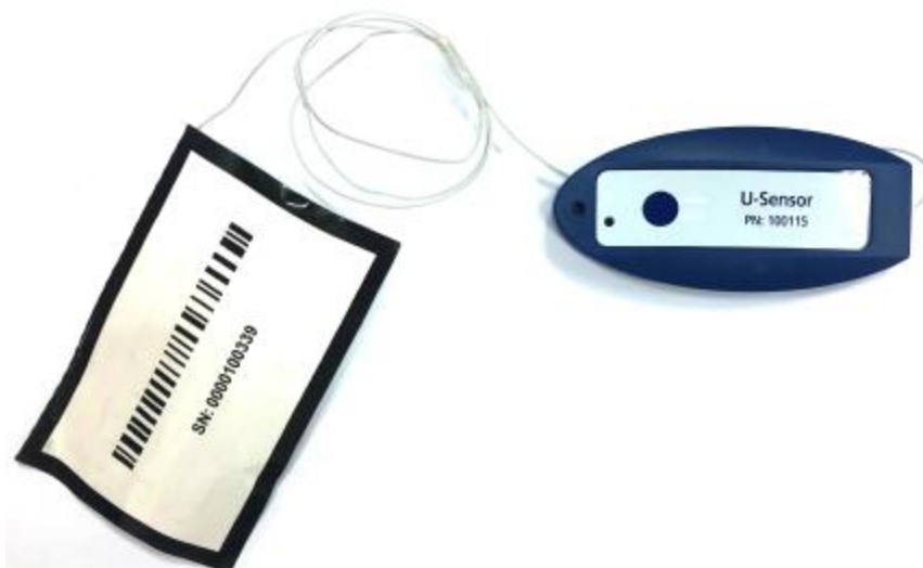
Рисунок 2 – Общий вид датчиков температуры и относительной влажности (датчиков) U-sensor
