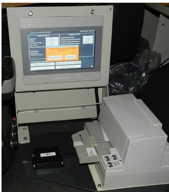
Рисунок 3 – Общий вид составных частей системы (БСК-01 с закрытой защитной крышкой, ПОС-10, идентификатор пользователя и принтер) в кабине средства заправки
