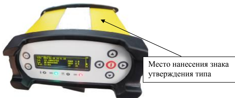
Рисунок 2 – Общий вид аппаратуры E-Survey Net20 Plus с указанием места нанесения знака утверждения типа
