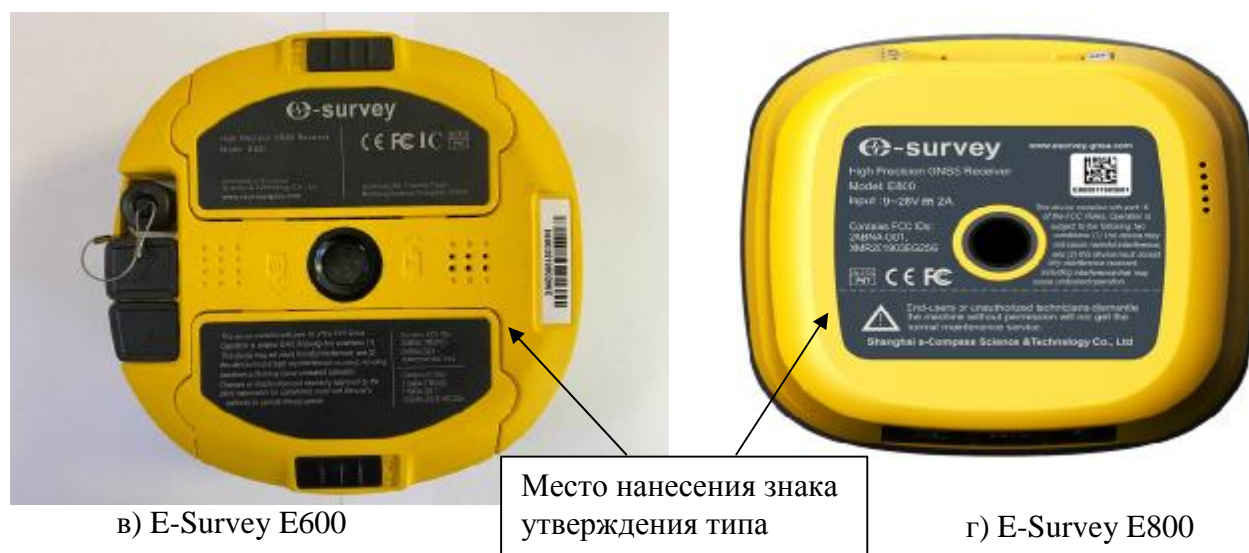
Рисунок 3 – Общий вид аппаратуры (смарт-антенны) со стороны нижней панели с указанием места нанесения знака утверждения типа
