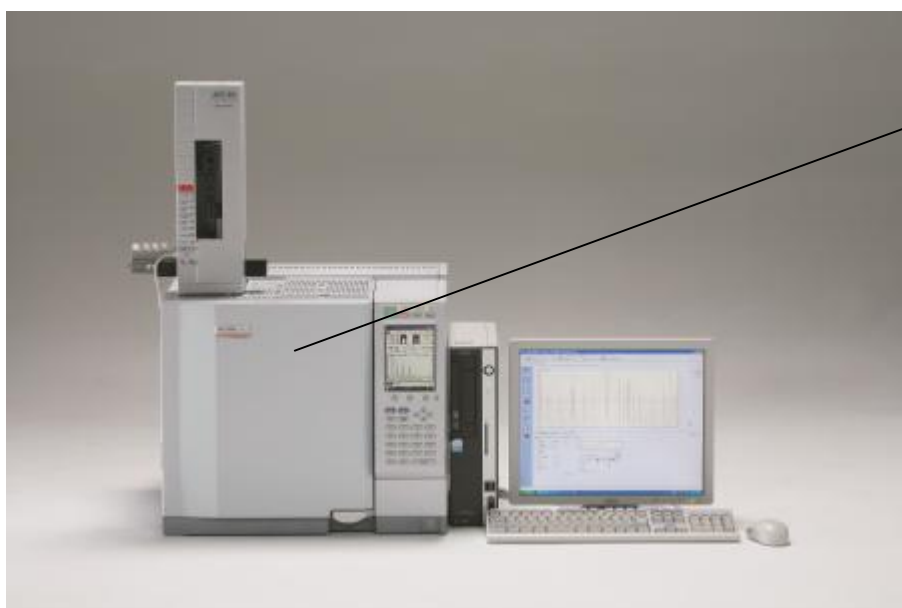
Рисунок 2 - Общий вид хроматографа GC-2010Plus
