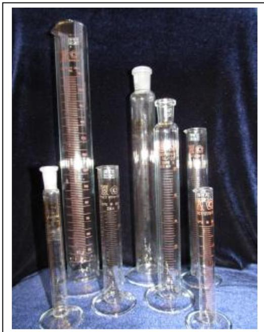
Цилиндры представляют собой градуированные стеклянные сосуды цилиндрической формы с носиком или конусной горловиной под пробку и стеклянным или пластмассовым основанием. У цилиндров числовые обозначения шкалы наносятся в восходящем от дна порядке, т.е. число, равное номинальной вместимости, указывается сверху.
