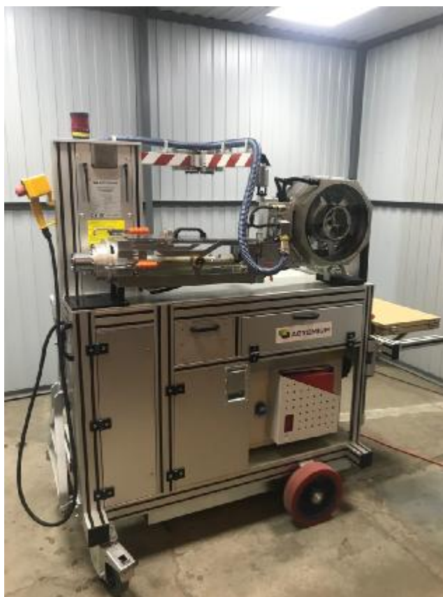
Рисунок 1 – Общий вид установки ультразвукового контроля полых осей колесных пар SHUTTLE R
