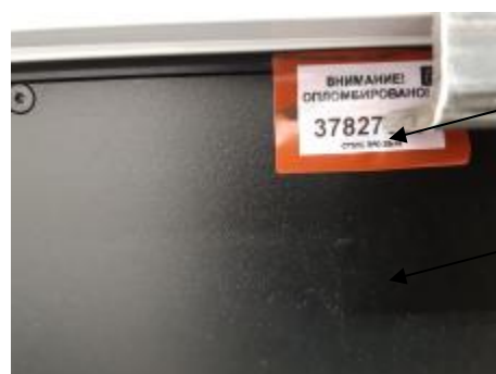
Рисунок 3 –Схема пломбировки от несанкционированного доступа, обозначение места нанесения знака поверки
