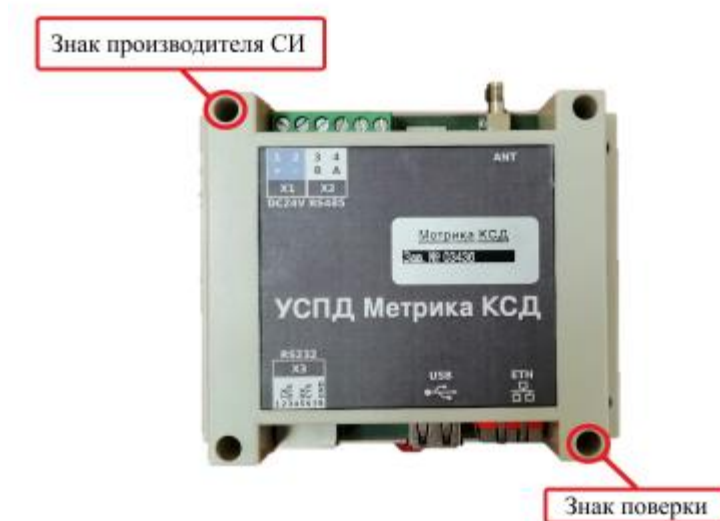
Рисунок 2 – Схема пломбировки УСПД
