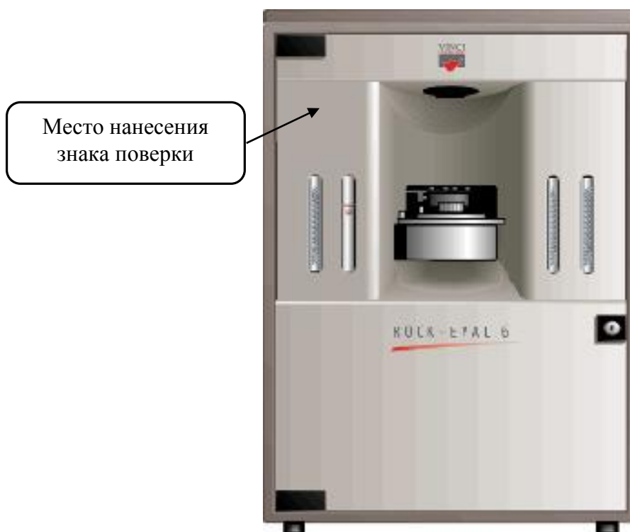
Рисунок 1 – Общий вид анализатора горных пород Rock-Eval 6 Standard, обозначение места нанесения знака поверки
