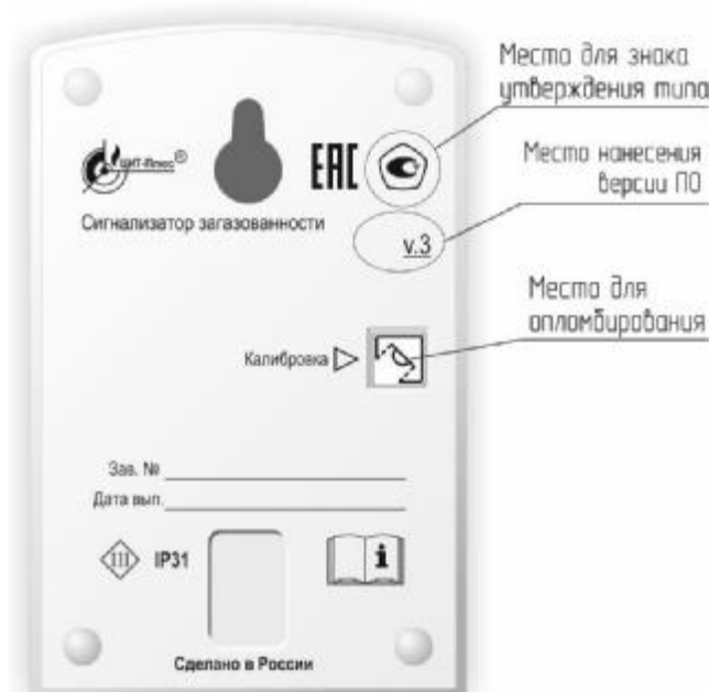
Рисунок 2 – Место установки пломбы сигнализаторов исполнений СЗ-3-1Аi, СЗ-3-1Аi/485
