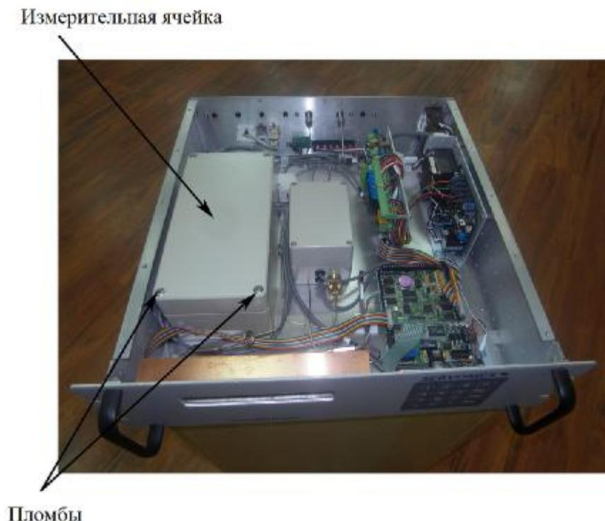
Рисунок 2 – Место пломбирования измерительной ячейки
