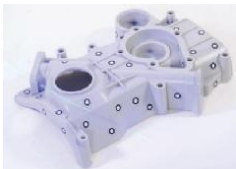
Рисунок 1 - Общий вид меток и пример их нанесения на объект сканирования
