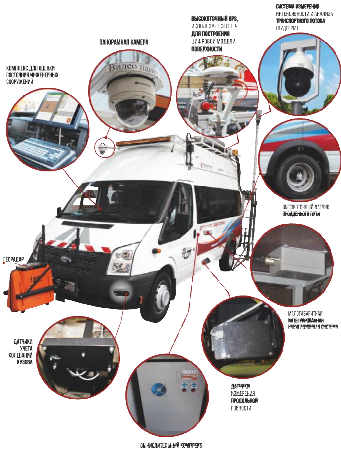
Рисунок 1 - Общий вид комплексов измерительных передвижных дорожных лабораторий ТРАССА 2
