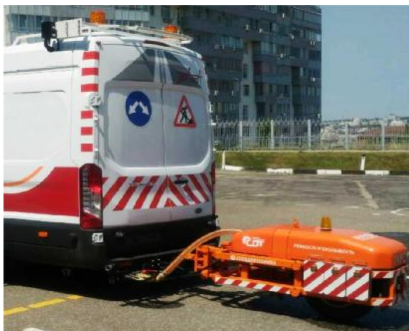
Рисунок 3 - Общий вид комплексов измерительных передвижных дорожных лабораторий ТРАССА 2 с прицепным устройством ПКРС
